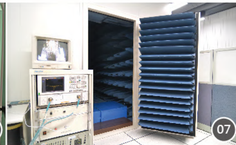
Far Field Chamber 3D無反射實驗室
