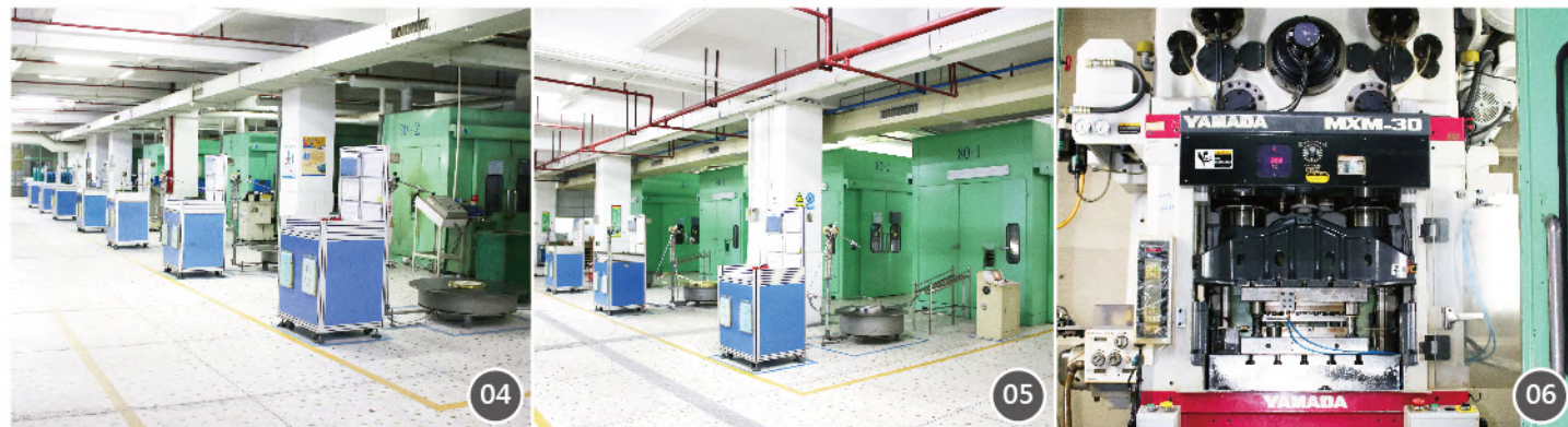
04 High Speed Stamping Workshop 高速沖壓車間 05 Large Tonnage Stamping Workshop 大噸位沖壓車間 06 High Speed Presses (Speed up to 1300 Times Per Minute) 高速沖床(衝速高達1300次/分鐘)
