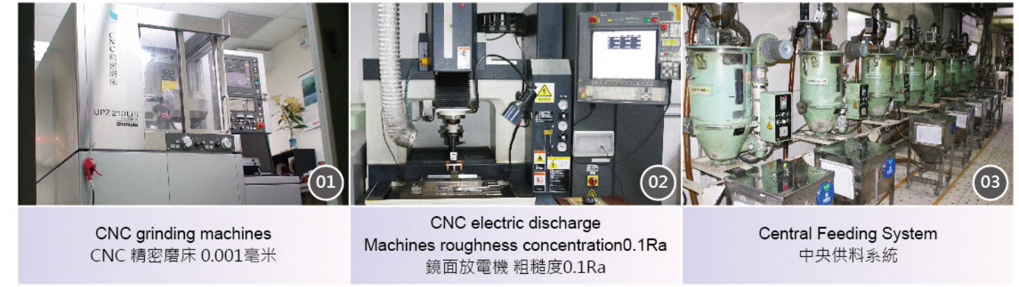
01 CNC grinding machines CNC 精密磨床 0.001毫米 02 CNC electric discharge Machines roughness concentration 0.1Ra 鏡面放電機 粗糙度0.1Ra 03 Central Feeding System 中央供料系統
