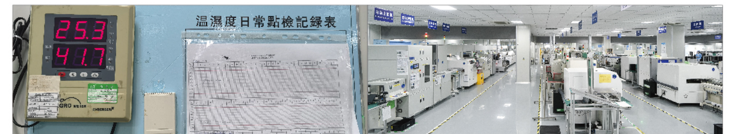
Automatic Alarm Temperature and Humidity Meter 自动报警温湿度计及人员定时点检
